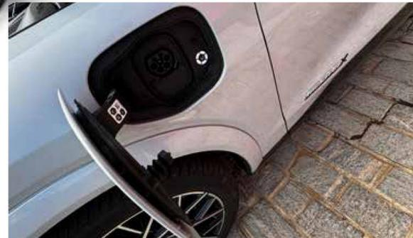
Detalhe da entrada de carregamento do Mustang Mach-E, modelo 100% elétrico da Ford.
